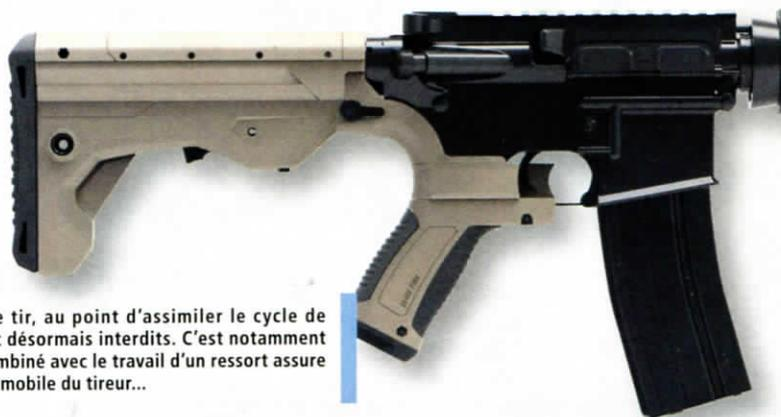
Les dispositifs augmentant la cadence de tir, au point d'assimiler le cycle de fonctionnement de l'arme à une rafale, sont désormais interdits. C'est notamment le cas des crosses "bump fire", où le recul combiné avec le travail d'un ressort assure le va-et-vient de la détente contre le doigt immobile du tireur...
